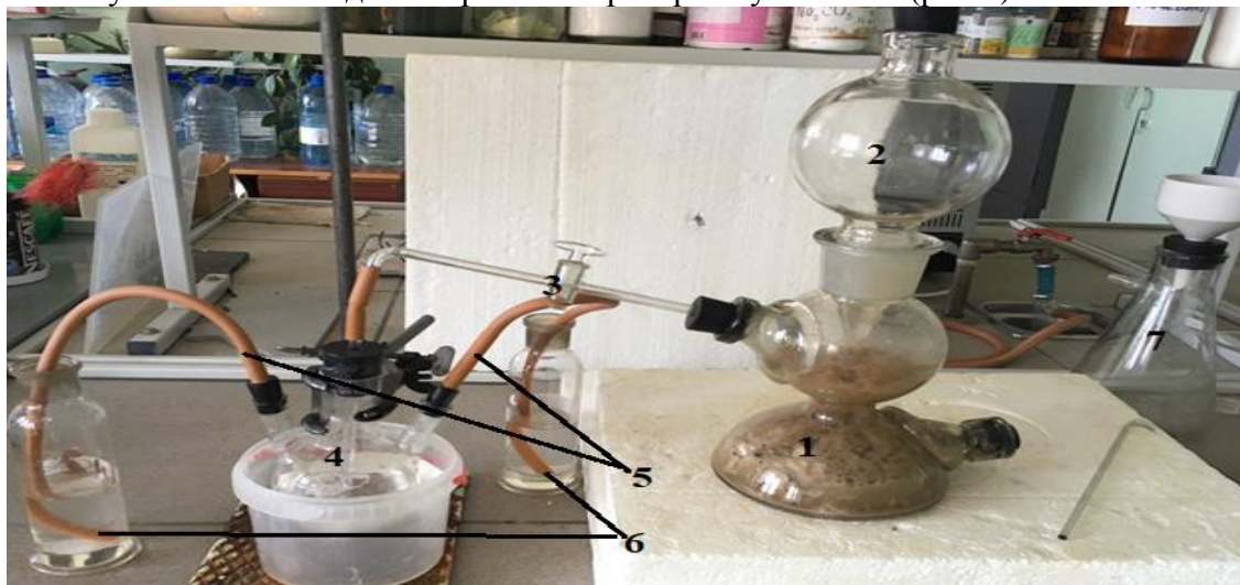
Рисунок 1- Лабораторная установка получения бикарбоната натрия 1-Аппарат Киппа, 2- воронка с длинной трубкой, 3- клапан, 4- круглодонная трехгорлая реакционная колба, 5- газоотводные трубки, 6- сборники избытка углекислого газа
