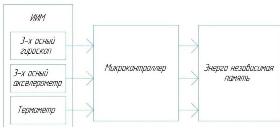
Рисунок 1 – Функциональная схема бортового самописца
